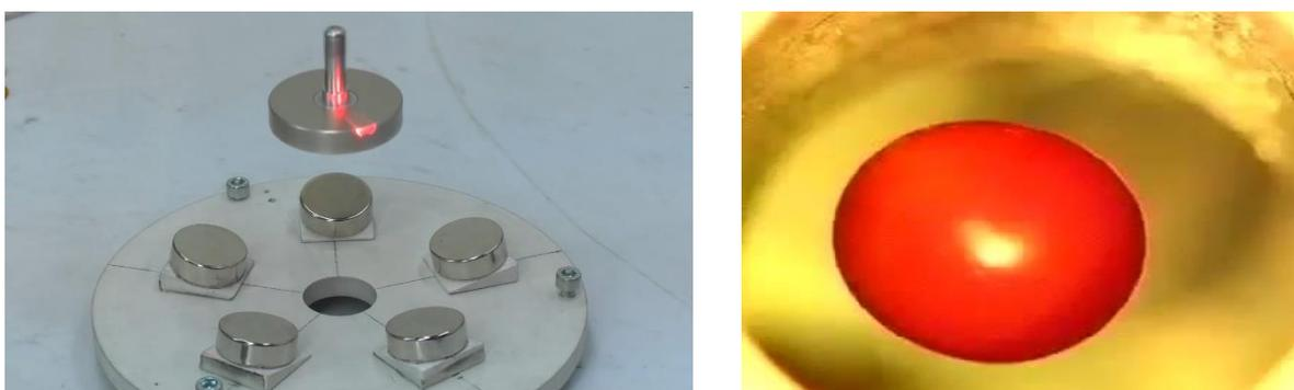
Рис.51. Левитация ферромагнетика и помидора (диамагнетика) в сильных магнитных полях
