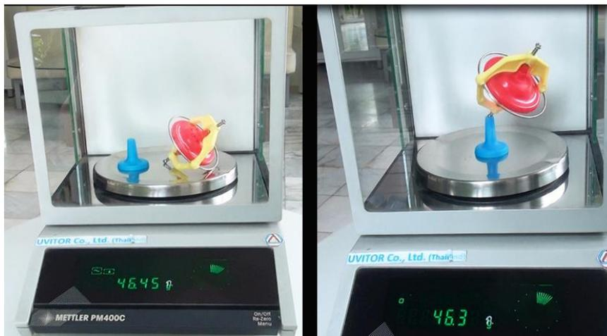
Рис.22. Слева измерен вес подставки и гироскопа без прецессии; справа вес того же гироскопа на подставке во время его прецессии
